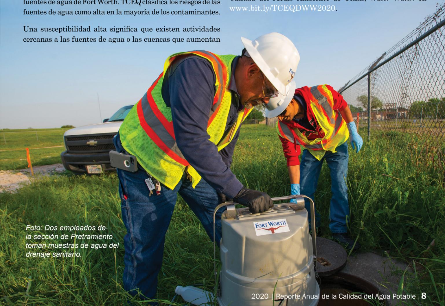
Foto: Dos empleados de la sección de Pretratamiento toman muestras de agua del drenaje sanitario.
